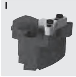
首先根据加工需要的齿轮外径，选择匹配的顶爪（尺寸1-6）。每一种尺寸的顶爪通过选配两种不同的夹紧销（型号A和B），可以兼容 20mm 的外径变化范围。一套顶爪包含 3 个爪以及一个 Keylock。
