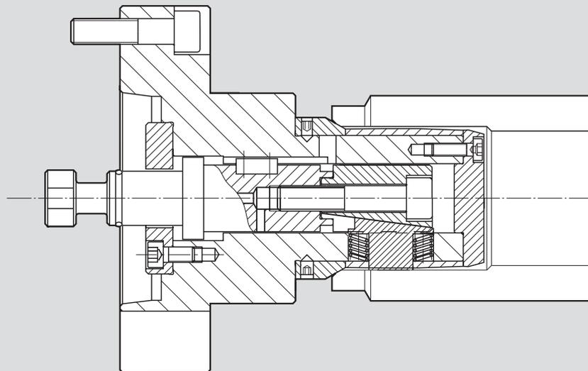
示例: 特殊膨胀芯轴，双锥式设计，带伸缩式定位，用于夹持定子
