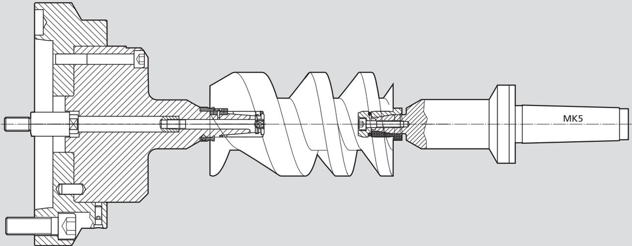
示例: 管子加工用分段式膨胀芯轴
