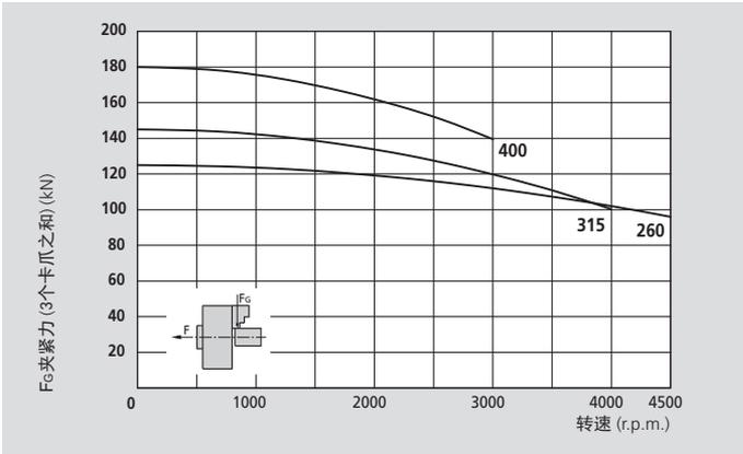
本图表中的数据适用于3爪卡盘, 并且根据维修手册, 使用SMW-AUTOBLOK K67润滑脂, 最新润滑的情况下使用标准软爪夹持在不超出卡盘外径处测量静态和动态夹紧力。
