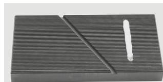
добавьте шлифовальный наполнитель (зерн.320) ближе к краю плиты
