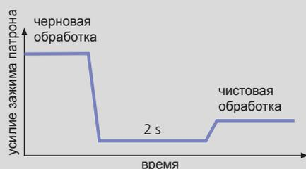
В указанной выше комбинации клиноременная система KNCS-NB/KNCS-NBX позволяет осуществлять управляемое снижение усилия зажима.
