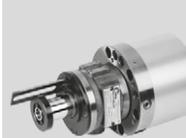
закрытый гидроцилиндр для "пограничного" зажима со встроенными предохранительными клапанами, контролем хода поршня; проходное отверстие для воздуха, масла и СОЖ (р<sub>макс.</sub> = 70 бар)
